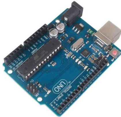
Figura 28. Arduino UNO R3: microcontrolador ATmega328 (fuente: electrocrea.com).
